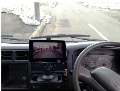
本機はWiFi規格の無線LAN親機として動作しますので、WiFiに対応したスマホやタブレットPC等をカメラ映像のモニター機器として利用することができます。モバイルインターネット通信に比べ、遅延の少ないリアルタイムなモニタリングが行えますので、トラックやダンプなどで配線不要のバックモニターとして活用することができます。
